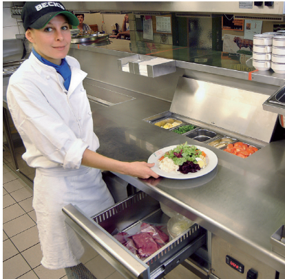
Die Kälte in den Kühltürblenden wird gleichzeitig für die Kühlung von Garnituren und Salaten genutzt.
